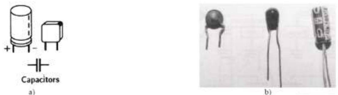
Fig. 7: a) Encapsulamentos típicos de condensadores polarizados (esquerda) e não polarizados (direita), e seu símbolo esquemático; b) Exemplos de condensadores comerciais: à esquerda, condensador cerâmico de 0.1mF, no meio, condensador de tântalo de 10mF e à direita condensador eletrolítico de 10mF.
