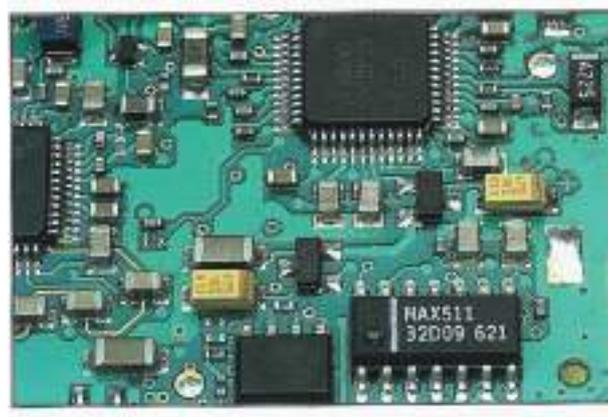
Fig. 27 – Exemplo de PCB com tecnologia S.M.T.
