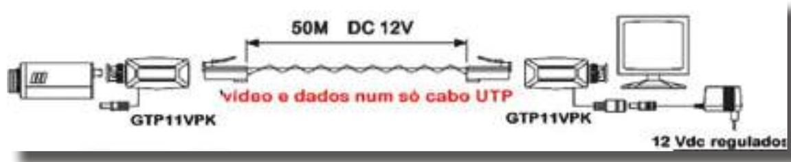
Passagem de sinal de vídeo e alimentação do conversor e câmara por cabo UTP sem utilização de cabo de corrente a uma distância de 50Mts.
